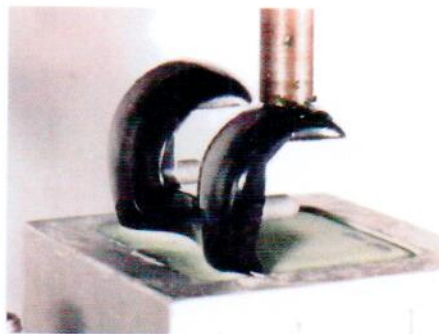
Bij belasting heeft Oxinium ® dezelfde karakteristieken als die van chroomcobalt.
